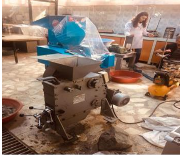
Şekil 3.8 Taş Kırma ve Boyutlama Makinesi
