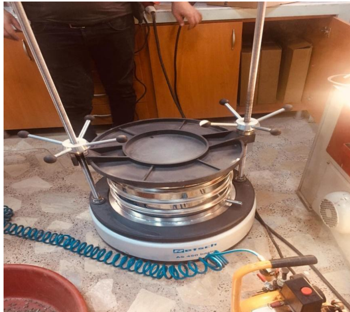
Şekil 3.9 Elek Takımı ve Eleme Makinesi
