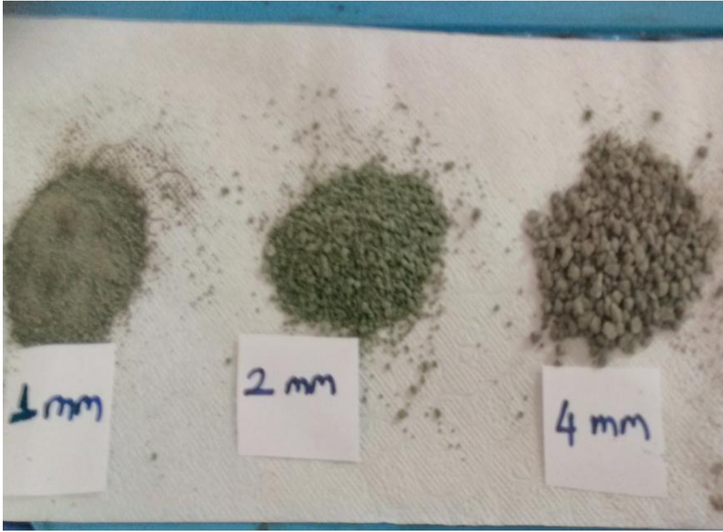
Şekil 3.10 Boyutlandırılmış Analsim Taşı
