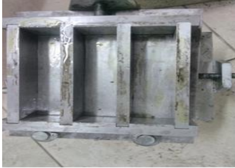
Şekil 3.14 Numune Kalıbı (4x4x16cm)
