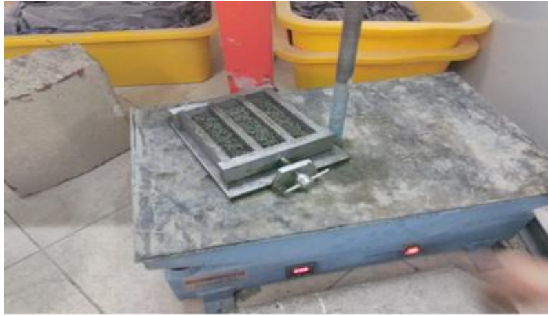
řekil 3.16 Sarsma Tablası Har Numunesi (40x40x160mm)
