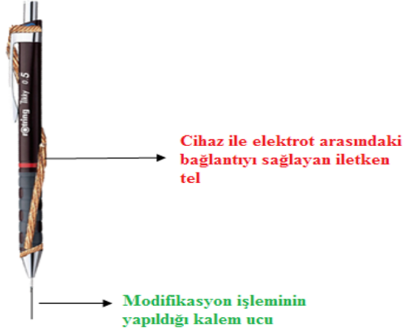
Şekil 3.3 Deneyde kullanılmak üzere hazırlanmış olan kalem grafit elektrot
