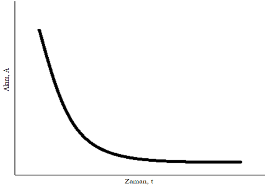
Şekil 3.2 Sabit potansiyelli elektroliz sırasında akım değişimi
