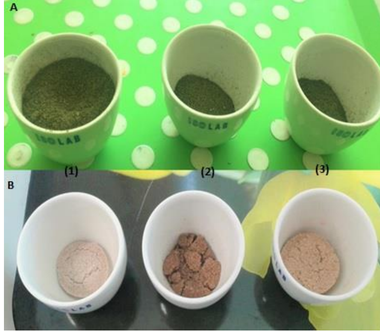
Şekil 3.7 (A) Kuru Bitki Numuneleri (B) Yakıldıktan Sonra Bitki Numuneleri. (1) S. polyrhiza (2) L. trisulca (3) S. natans
