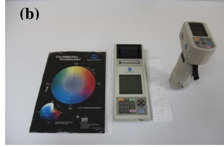
Şekil 3.10. Polen peletlerinde renk ölçme işlemi (a) ve renk ölçer cihazı (b)
