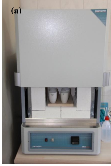
Şekil 3.15. Kül fırınındaki porselen krezeler (a) ve yakılmış polen peletleri (b)
