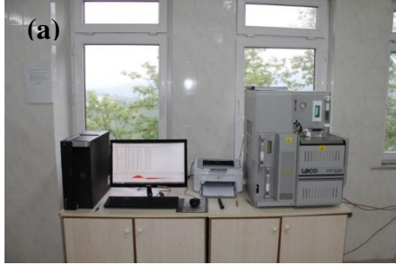
Şekil 3.14. Protein analiz cihazı (a) ve alüminyum kapsüllerin cihaza yerleştirilmesi (b)
