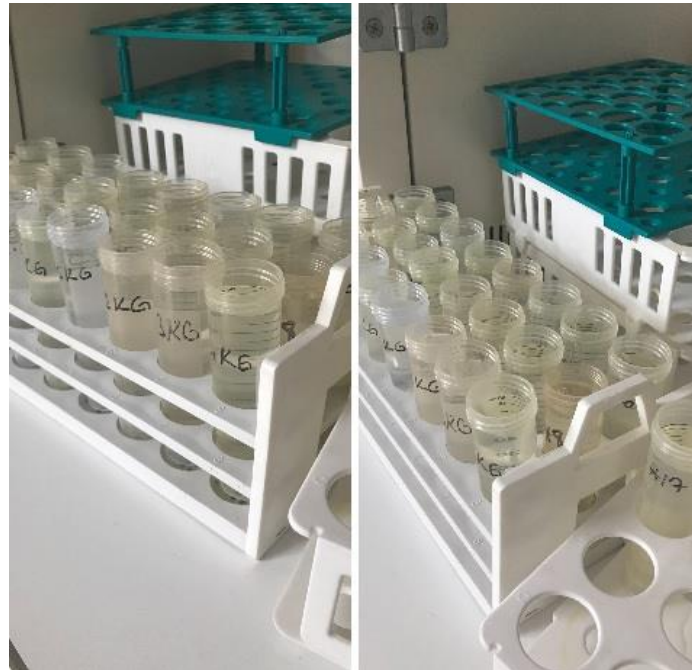
Şekil 3.4.2 ICP-MS okumalarına hazırlanan numuneler
