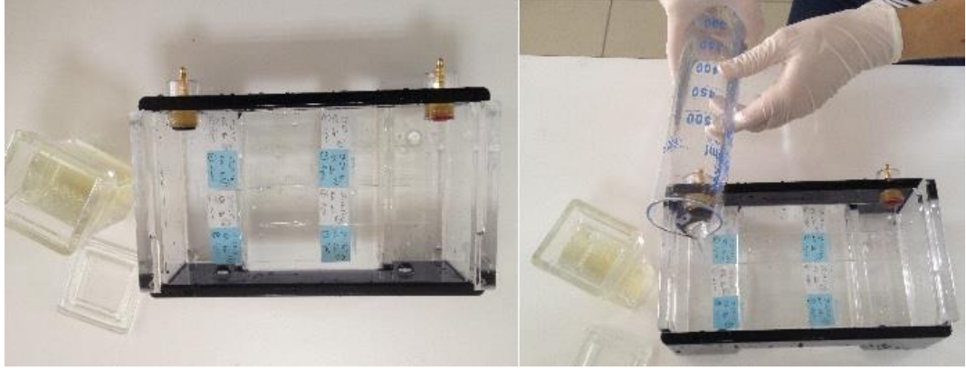
Şekil 3.5.1.2.2.6 Lizis solüsyonundan çıkarılan lamaların elektroforeze hazırlanması
