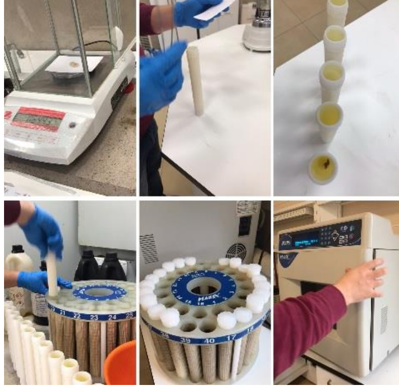
Şekil 3.4.1 Balık dokularının ICP-MS okumalarına hazırlanması
