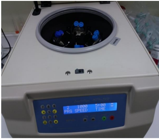
Şekil 3. 18. Örneklerin santrifüj edilmesi
