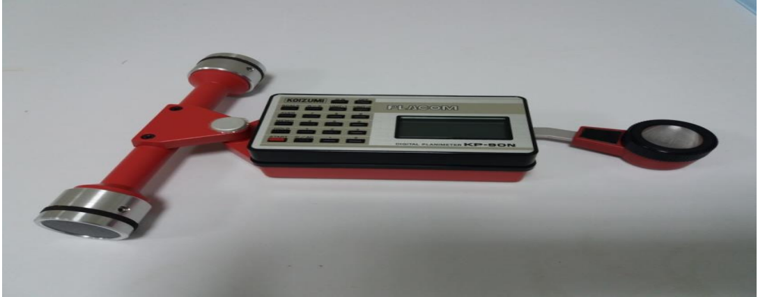
Şekil 3.13. Çalışmada kullanılan planimetre
