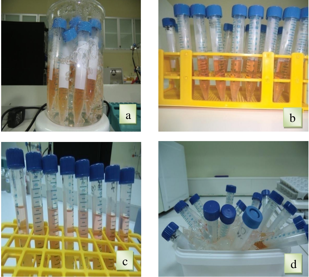
Şekil 3.15. Prolin analizinin hazırlık aşamaları (a: Analiz için hazırlanan numuneler, b: Örneklerin 100°C de inkübe edilmesi, c: İnkübe edilen örneklerin buz banyosuna alınması, d: Analiz için çalışma standartlarının hazırlanması)
