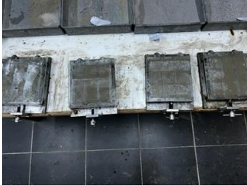
Şekil 4.6 Kalıplara Yerleştirilmiş Mikro Beton Numuneleri
