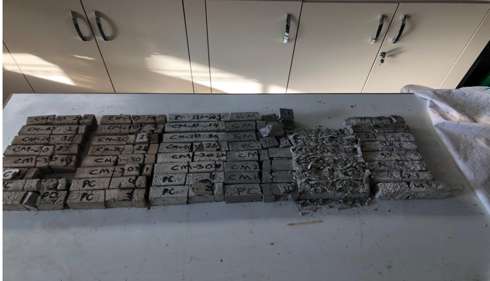
Şekil 4.11b Yangın Etkisinde Kalmış Mikro Beton Numuneler
