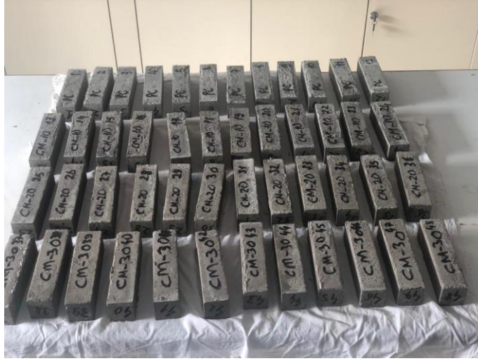
Şekil 4.8 Kalıplarından Çıkartılan Numuneler
