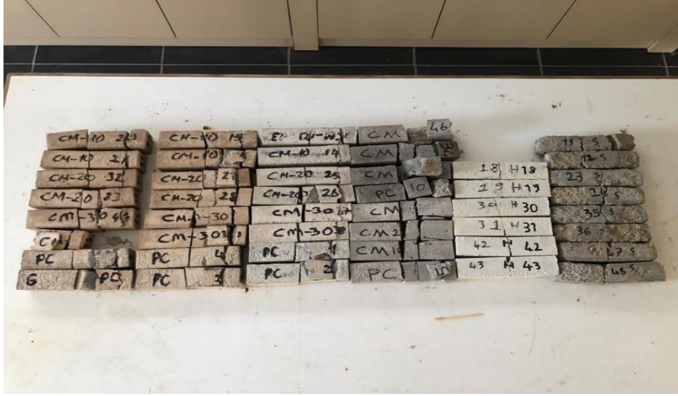
Şekil 4.11a Yangın Etkisinde Kalmış Mikro Beton Numuneler
