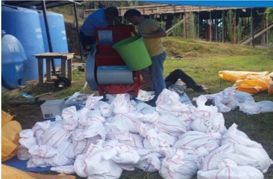
Şekil 3.6. Patozda çotanaktan danelerin ayırma işlemi
