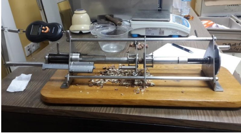
Şekil 3.8. Kabuk kırılma direnç ölçer
