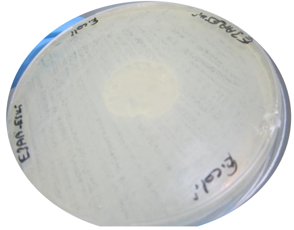
Şekil 3.11. 10 mm PAcHP diskinin E. coli bakterisi ile etkileşimi sonucu antibakteriyel etki gözlenmemiştir.
