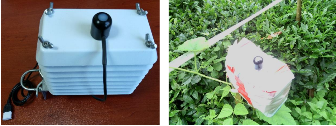
Şekil 3.3. Sıcaklık, nem ve par ölçümünde kullanılan cihaz
