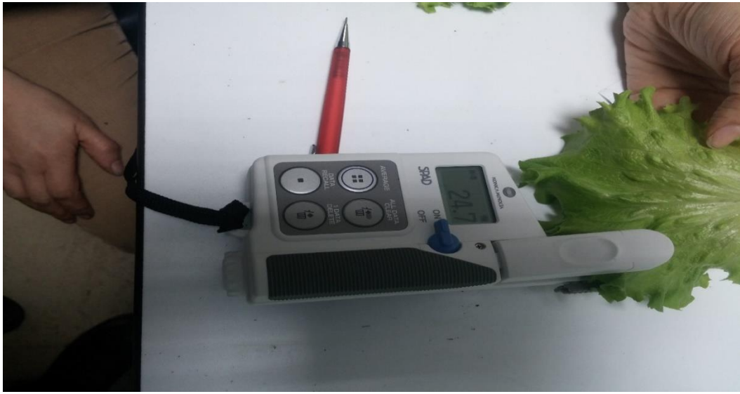
Şekil 3.4 Marul bitkilerinde SPAD ölçümü
