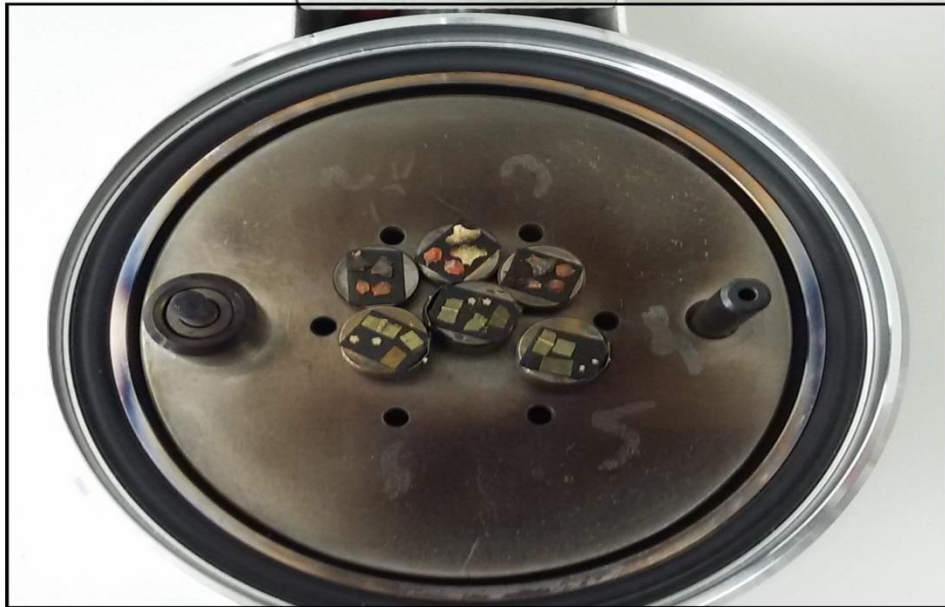
Şekil 3.11. SEM çekimine hazırlanan, sabitlenmiş altın kaplamalı numuneler
