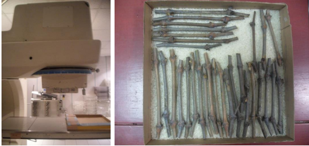
Şekil 3.3 Co 60 Uygulama Cihazının ve Işınlaması Yapılan Odun Çeliklerinin Görünümü
