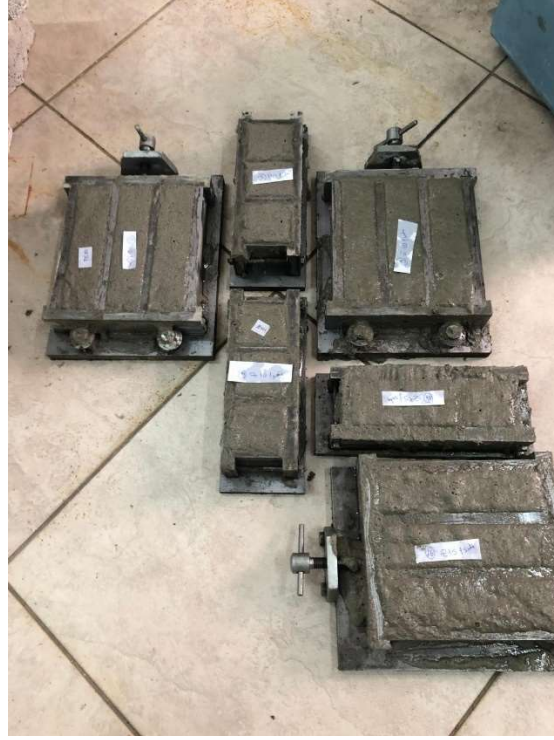
Şekil 3.13 Köpük Beton Kalıpları
