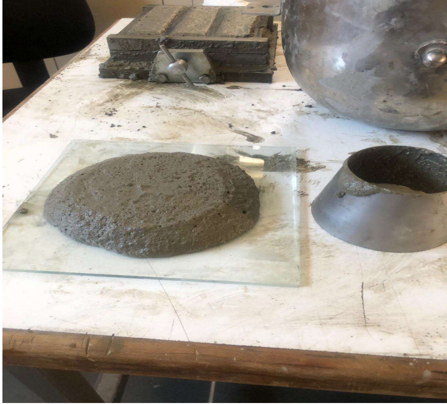
Şekil 4.2 Yayılma Deęerlerinin Belirlendięi Deney Anına Ait Bir Görünüm
