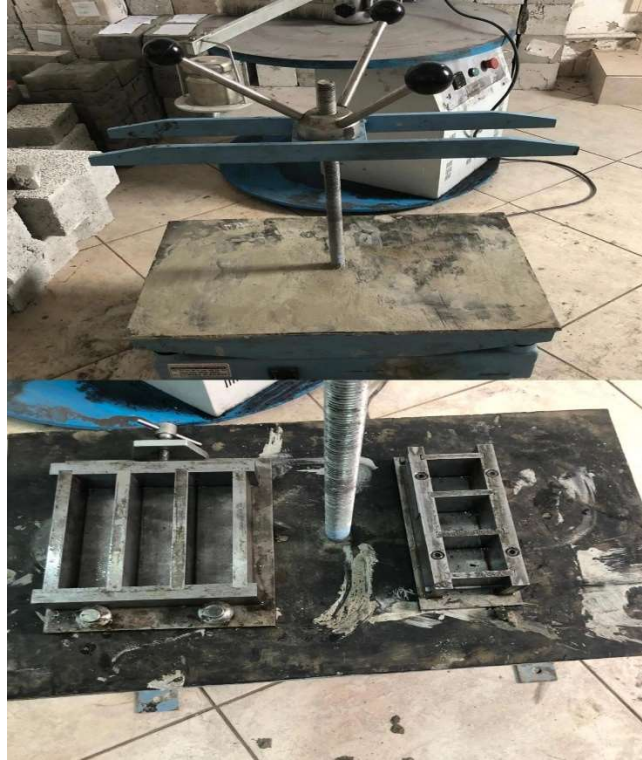
Şekil 3.14 Numunelerin Üretiminde Yerleştirmede Kullanılan Sarsma Tablası
