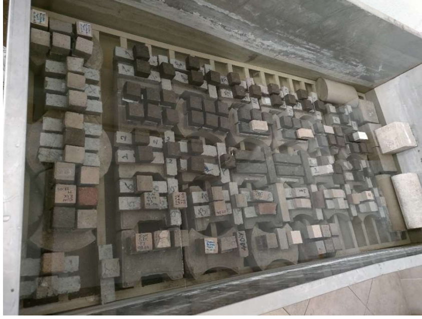
Şekil 3.17 Kür Havuzunda Bekletilen Numuneler
