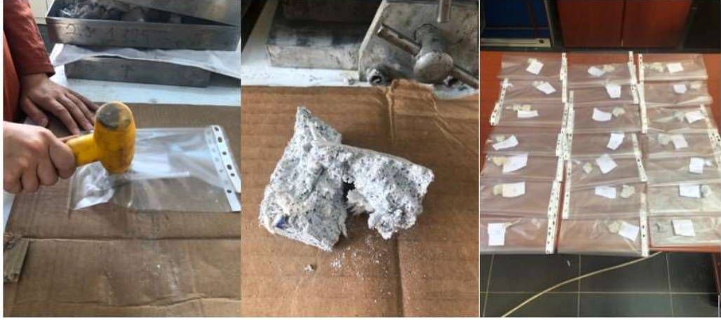
Şekil 4.12 Üretilen Köpük Betonların Analize Hazırlık Aşamaları
