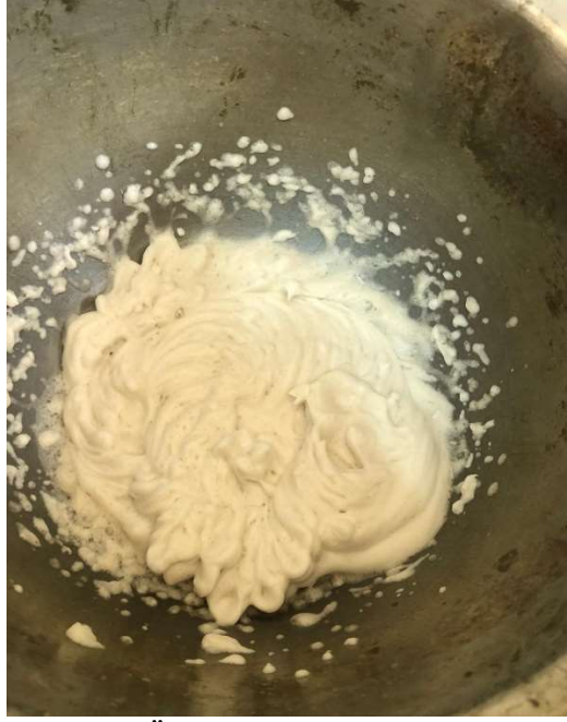
Şekil 3.11 Köpük Beton Üretiminde Kullanılan Köpük Kıvamı
