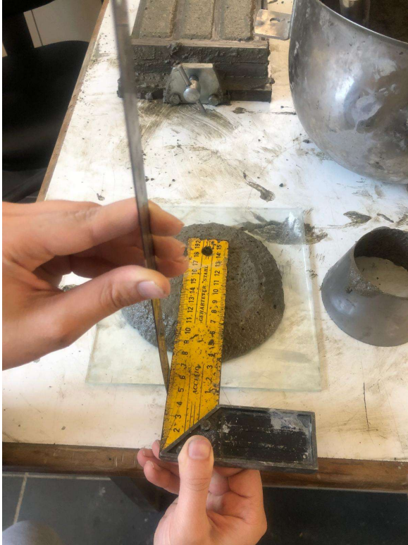
Şekil 3.19 Karışımın Çökme Değerinin Ölçüm Anı
