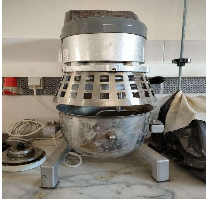
Şekil 3.10 Köpük Beton Karışımlarında Kullanılan Çimento Mikseri
