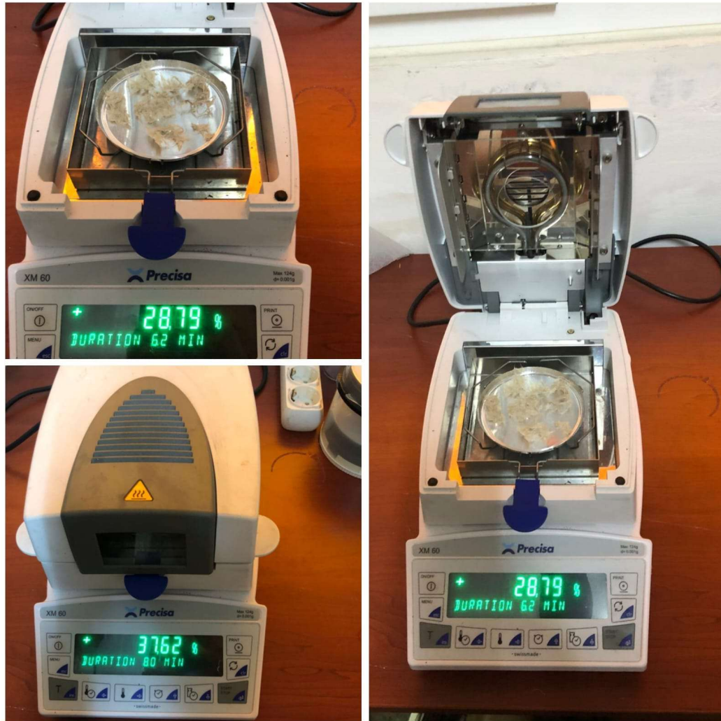
Şekil 3.7 Nem Tayin Cihazı ile Kuru Madde Miktarı Tayini
