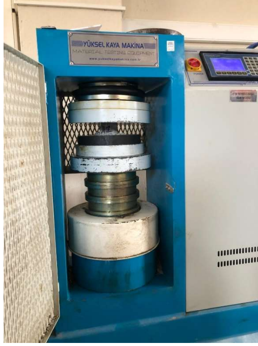
Şekil 3.26 Basınç Deney Anına İlişkin Bir Görünüm
