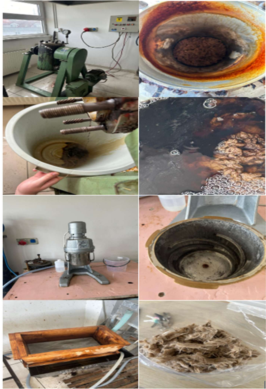
Şekil 3.6 Kenevir Lifleri İçin Yüze İşlemlerinde Kullanılan Cihaza Ait Görünümler ve İşlemden Geçmiş Numune
