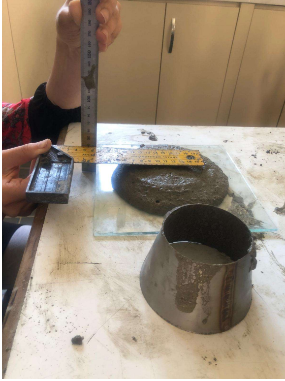
Şekil 3.18 Karışımın Çökme Deney Anı
