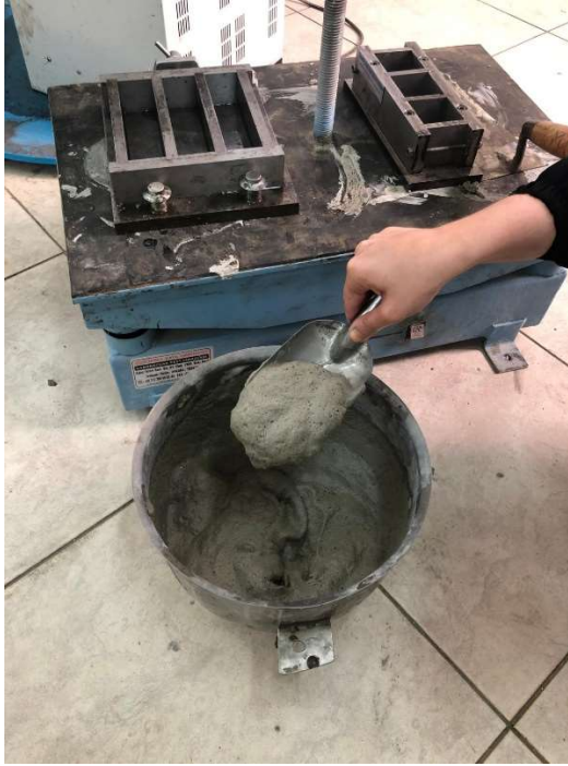
Şekil 3.12 Köpük Beton Numunelerin Kıvamı
