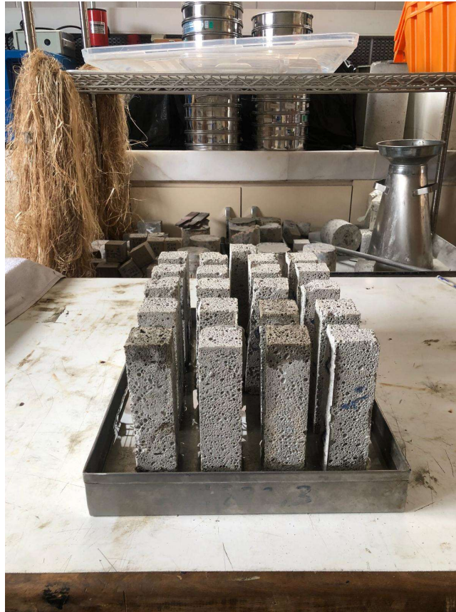
Şekil 3.22 Kılcal Su Emme Deney Anı
