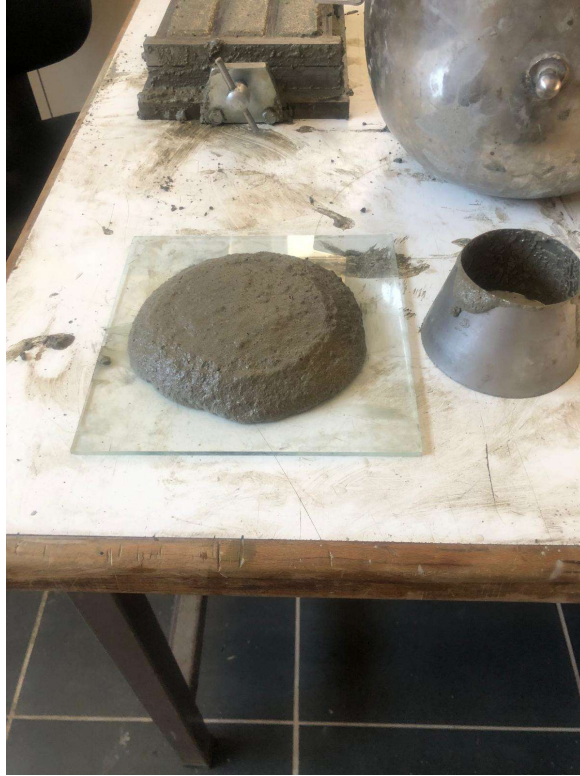
Şekil 3.20 Karışımın Yayılma Deney Anı
