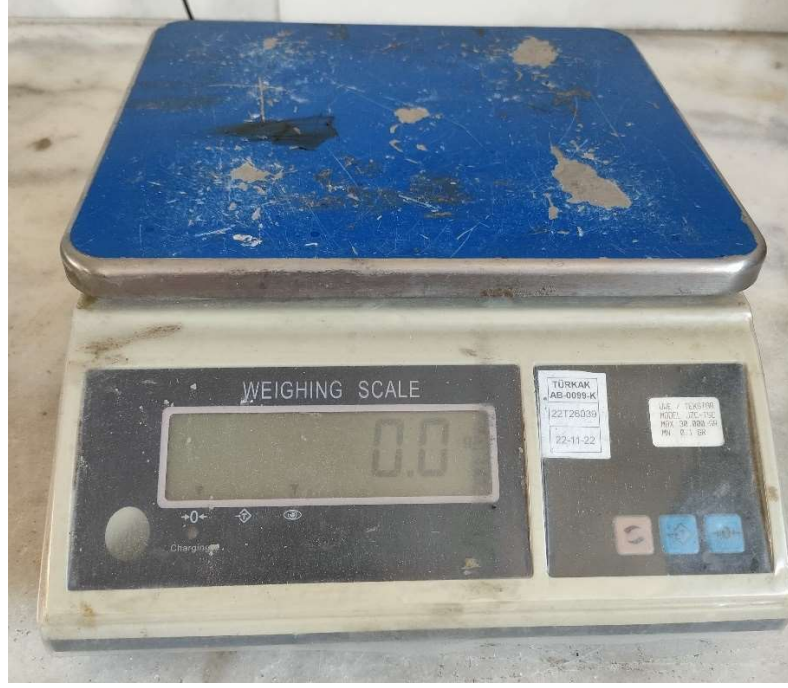
Şekil 3.8 Karışıma Giren Bileşen Miktarlarının Belirlendiği Hassas Terazî
