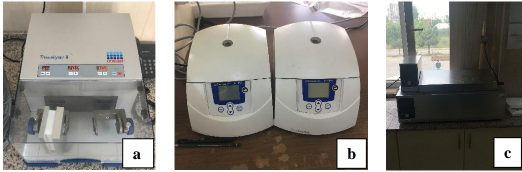
Şekil 3.20 DNA izolasyon aşamasında kullanılan cihazlar [doku parçalayıcı (a), santrifüj (b) ve sıcak su banyosu (c)]
