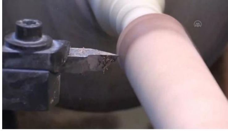
Görsel 4. 2 Tornaya bağlı bıçak yardımıyla gövdenin silindir hale getirilme işlemi (URL-24, 2023).
