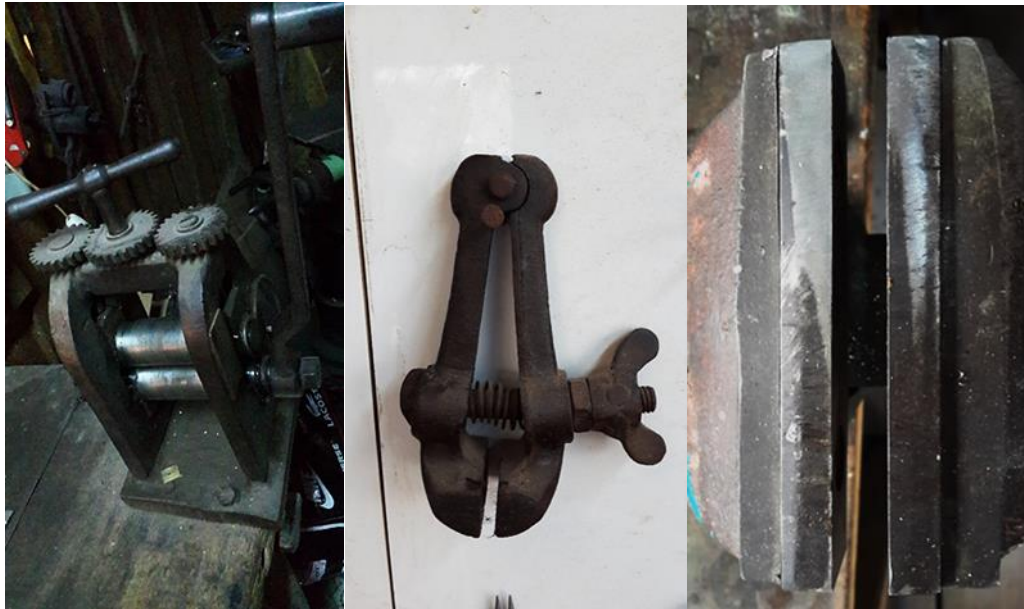
Görsel 4. 21 Kendi yaptığı takımlar soldan sağa doğru silindir, el mengersi ve mengine ağız
