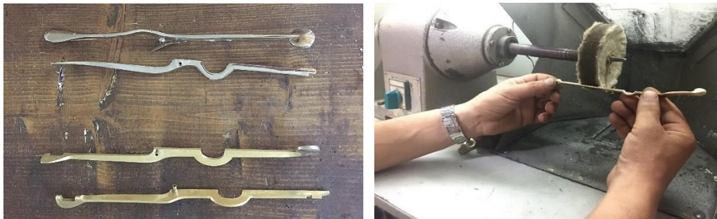
Görsel 4. 15 Nikel-altın kaplama ve polisaj işlemi
