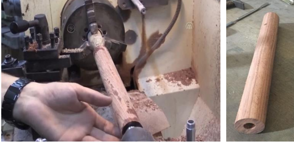
Görsel 4. 12 Tornada klarnetin gövde içinin oyma işlemi ve yarı mamul hale getirilmesi (URL-24, 2023).
