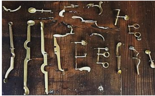
Görsel 2. 56 Klarnet gövdesine takılan anahtar (tuşe) takımı
