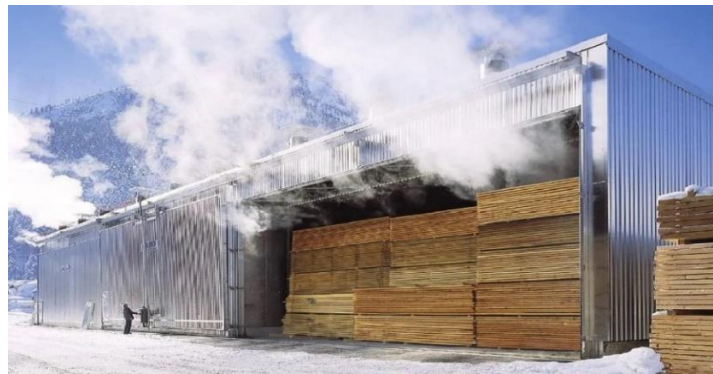
Görsel 2. 42 Teknik (fırlama) kurutma yöntemi (URL-32, 2022)
