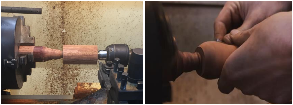
Görsel 4. 7 Tornada baril kısmına silindir şeklini verme aşaması
