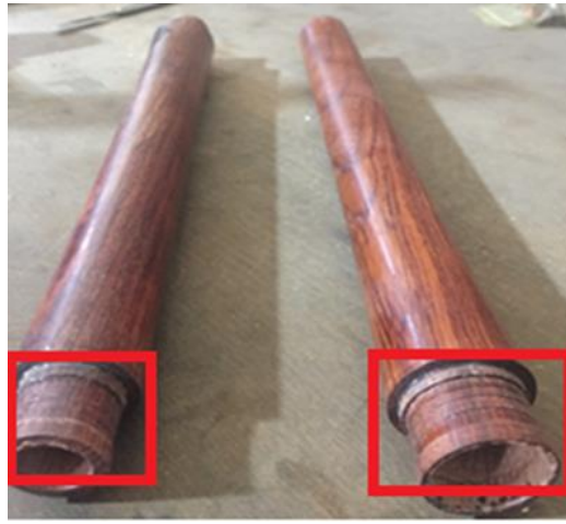
Görsel 4. 11 Yarı mamul üst ve alt gövde üzerinde “zıvana oyuğu”
