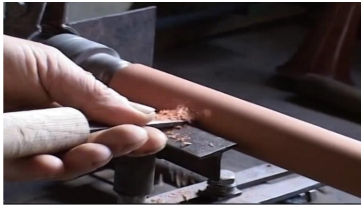
Görsel 4. 1 Kesici bıçağın elle tutularak ağaca silindir şeklinin verilmesi (URL-52, 2023).
