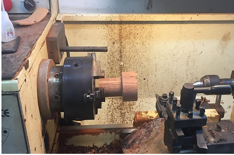
Görsel 4. 8 Tornada kalak kısmına silindir şeklinin verilme işlemi
