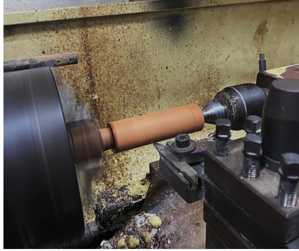
Görsel 4. 3 Tornada ağızlık kısmına silindir şeklinin verilmesi
