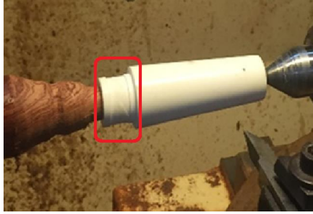
Görsel 4. 10 Tornada klarnet ağızlığına “zıvana oyuğu” işlemi
