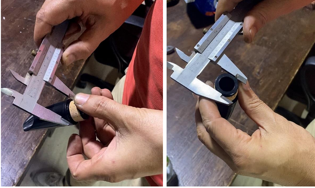
Görsel 4. 4 Ağzlık dış çapı ve baril ile ağzlığın bağlantı yeri
