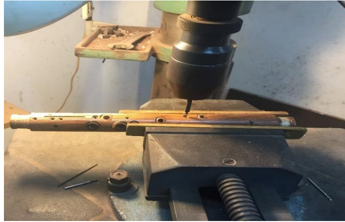
Görsel 4. 13 Ses perdelerinin açılma işlemi
