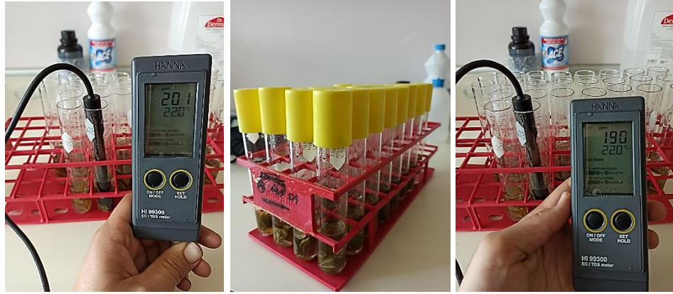
Şekil 3.14 İyon Akışı İçin Örneklerin EC Metre İle Ölçülmesi
