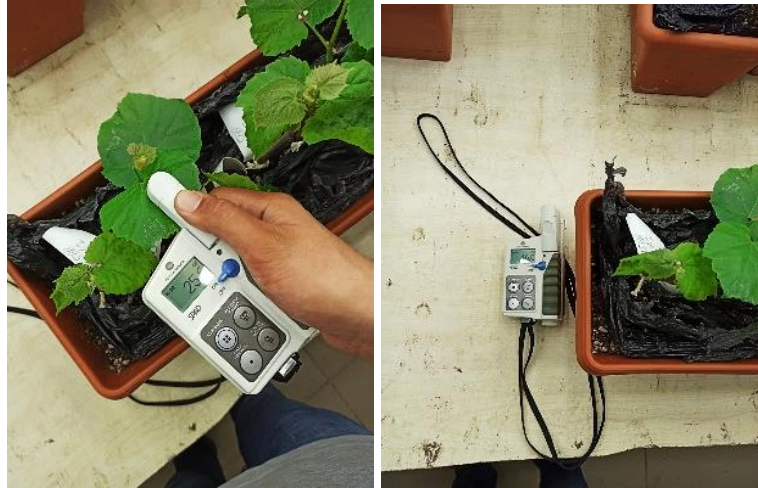
Şekil 3.16 SPAD cihazı yardımıyla yapraktan klorofil tayini
