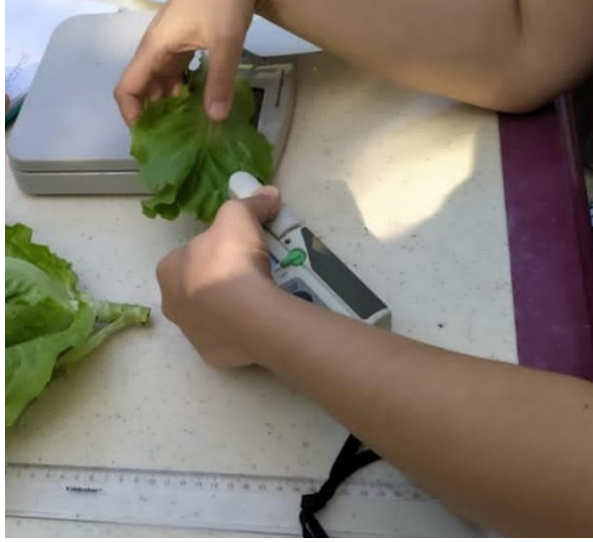
Şekil 3.14 Klorofilmetre cihazıyla klorofil ölçümü
