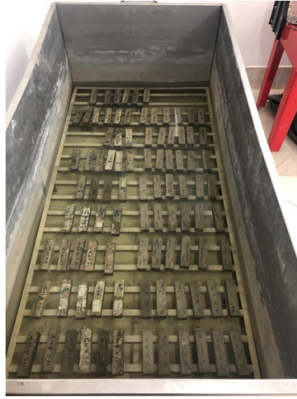
Şekil 4.5 Kür havuzundaki numunelere ait görünüm
