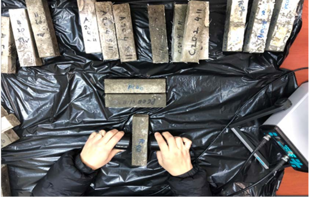
řekil 4.9 UPV Ölüm Cihazı ile Yapılan Deney Anından Görünüm
