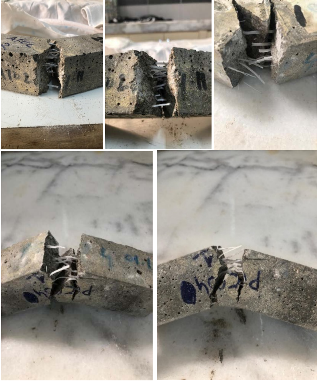
Şekil 5.9 Eğilmede çekme deneylerinde kırılmış numunelere ait görünüm
