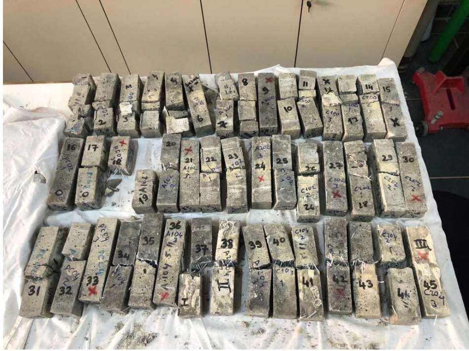
Şekil 5.10 Eğilmede çekme-basınç deneylerinde kırılmış numunelere ait görünüm
