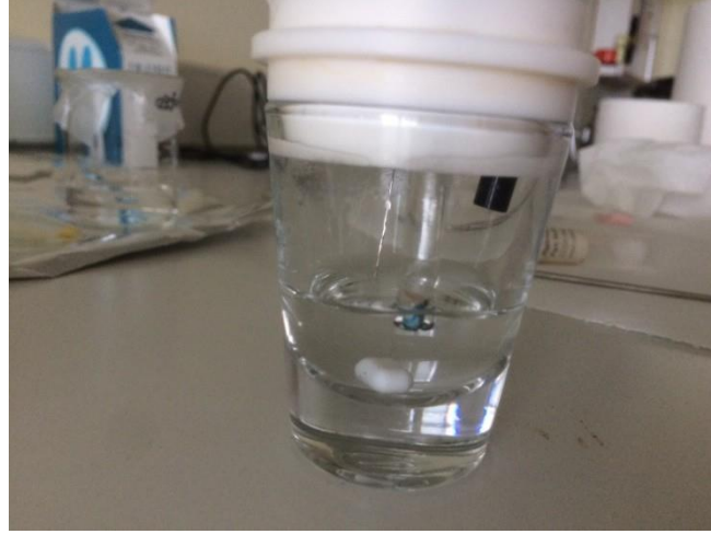
Şekil 3.6.1 Hazırlanan Voltametri Hücresinin Elektrotlar ile Gösterimi
