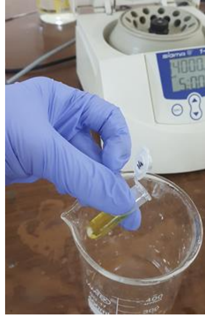
Şekil 3.20 Üst Kısımın Tüpten Uzaklaştırılması
