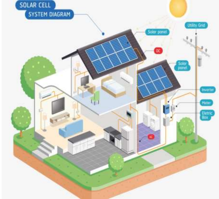
Şekil 3.3 Şebeke Bağlantılı Sistem Tasarımı
