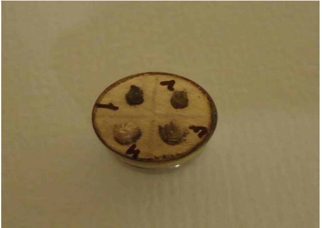
Şekil 4.55. Sabitlemiş altın kaplamalı numuneler
