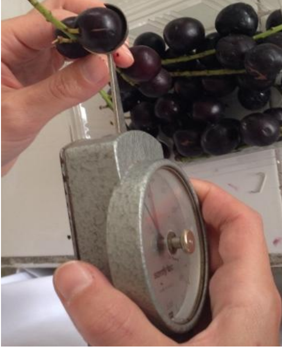
Şekil 3.4. Karayemiş meyveleri penetrometre ile salkımdan koparılarak ölçülmesi
