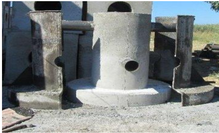
Şekil 3.10. Anti-trol resif imalatında kullanılan kalıplar
