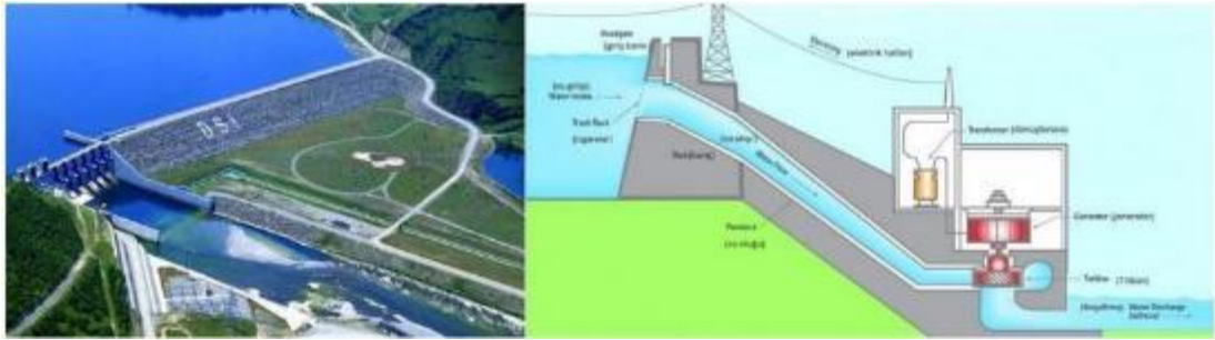
Şekil 1.3 Hidroelektrik Santral ve Hidrolik Enerji Üretim Şeması
