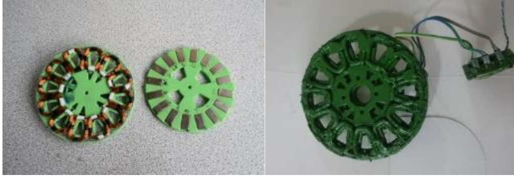
Şekil 2.22 Bobinler Stator ve 16 Miknatıslı Rotor
