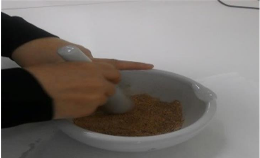
Şekil 3.2 Kurutulmuş Mantar Numunelerinin Toz Haline Getirilmesi
