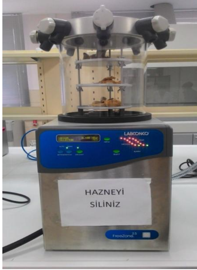
Şekil 3.1 Mantar Numunelerinin Liyofilizatörde Kurutulması
