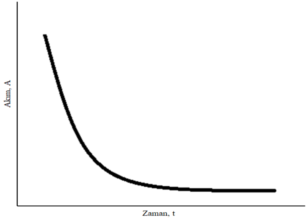
Şekil 3.3. Sabit potansiyelli elektroliz sırasında akım değişimi.
